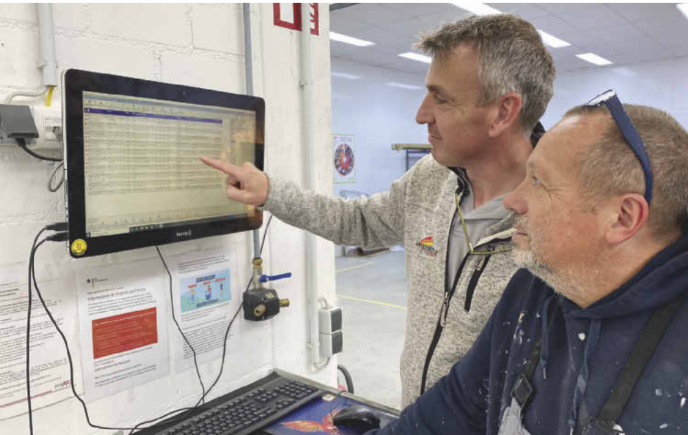
Sowohl im Karosserie- als auch im Lackierbereich sind Touchscreen-Bildschirme installiert, auf denen jeder Mitarbeiter seine Aufträge zugeordnet bekommt, die benötigten Infos erhält und stempeln kann. (Foto: LZ Entenbad)
